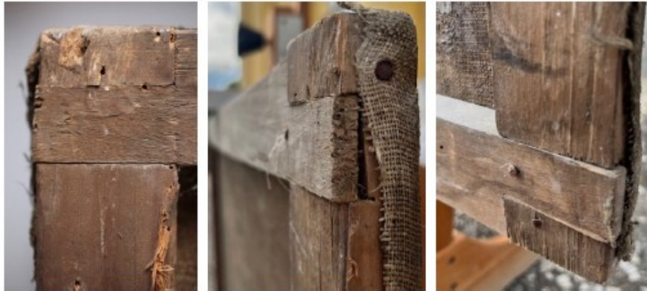
26-28. kép: A vakkeret merev, ékelhetetlen csapolási rendszere, a keretlécen durva megmunkálás nyomai
